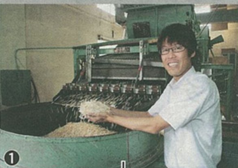
火薬成分を吸わないよう防じんマスクを着け、レシビ通りの分量で頭薬を調合
