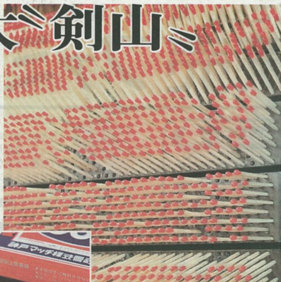
頭薬が付けられたばかりのマッチの頭はツヤツヤ、コンベヤーで移動させ、乾燥させるうちに丸く固まります。赤いマッチは「良質の目印」
